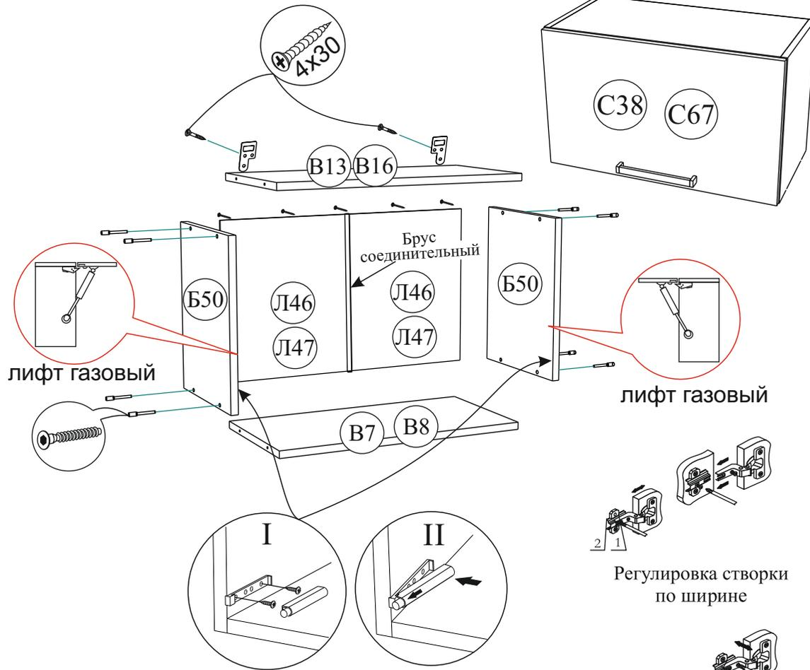
Схема установки толкателя
