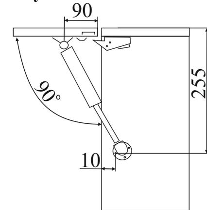
Регулировка створки по глубине
