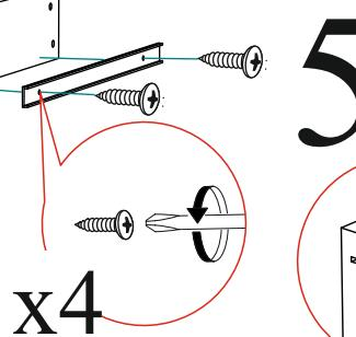
*Шариковые направляющие крепятся снизу боковины и плотную к фасаду.*
