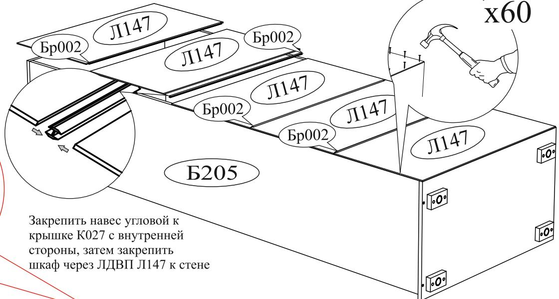
Закрепить навес угловой к крышке К027 с внутренней стороны, затем закрепить шкаф через ЛДВП Л147 к стене
