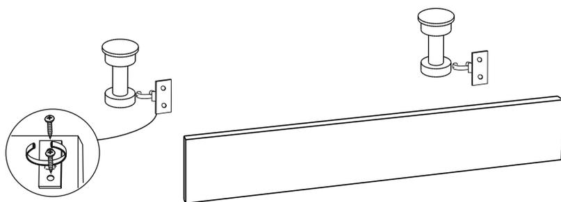
Для всех нижних секций предусмотрена возможность установки цоколя, для этого в комплекте фурнитуры заложены клипсы к опоре (черная), которая в этом случае крепится впереди и цоколь монтируется согласно схеме.
