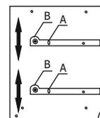
отверстие в точке А позволяет подогнать направляющую по высте. Затем необходимо закрепить положение направляющей в точке В, при помощи шурупа 4x16.
