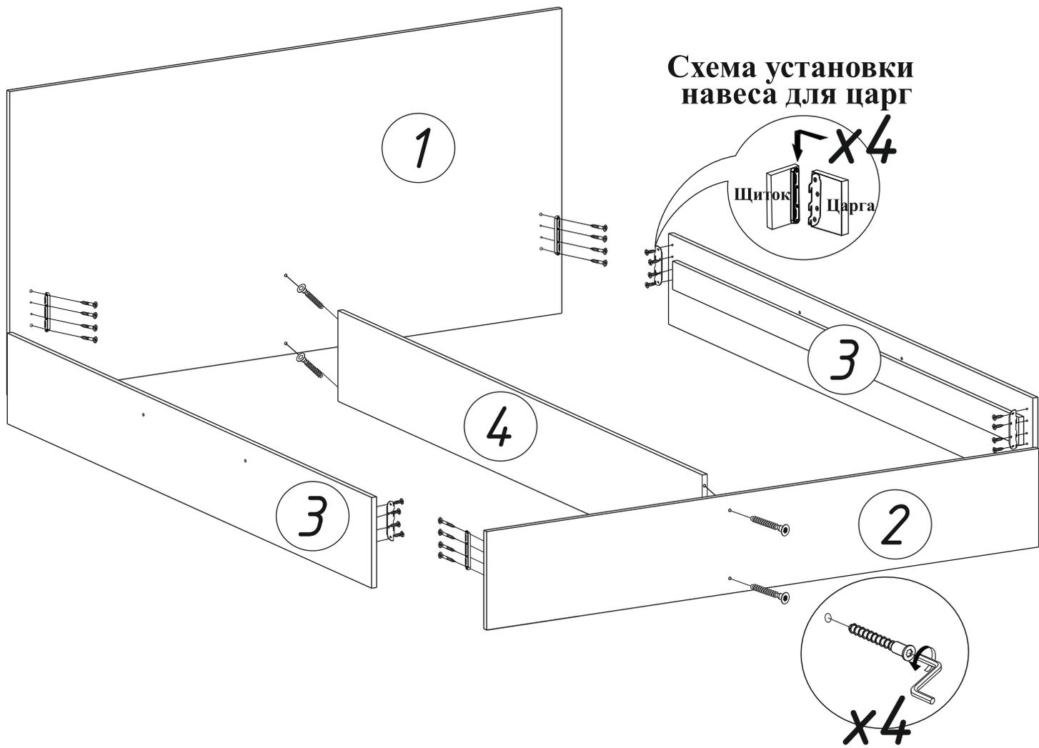
Для обеспечения более жесткой конструкции рекомендуем закрепить проложки к царгам при помощи евровинтов, для этого в царгах на внутренней стороне сделаны наметки.
