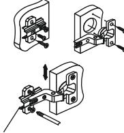
Регулировка створки по ширине      Регулировка створки по высоте
