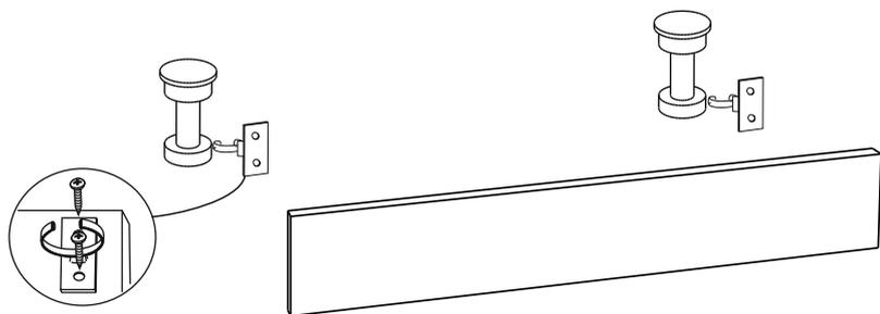
Для всех нижних секций предусмотрена возможность установки цоколя, для этого в комплекте фурнитуры заложены клипсы к опоре (черная), которая в этом случае крепится впереди и цоколь монтируется согласно схеме.
