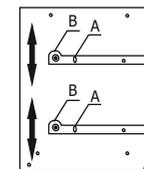
отверстие в точке А позволяет подогнать направляющую по высоте. Затем необходимо закрепить положение направляющей в точке В, при помощи шурупа 4x16.
