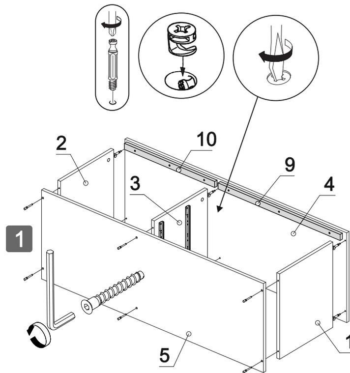
**ПЛАНКИ №9,10 ЗАКРЕПИТЕ С ПОМОЩЬЮ ШУРУПОВ 3x30 К ЗАДНЕЙ ЧАСТИ КРЫШКИ ДЕТА.№4 (ПЛАНКИ ИСПОЛЬЗУЮТСЯ ДЛЯ КРЕПЛЕНИЯ ЛДВП)**
