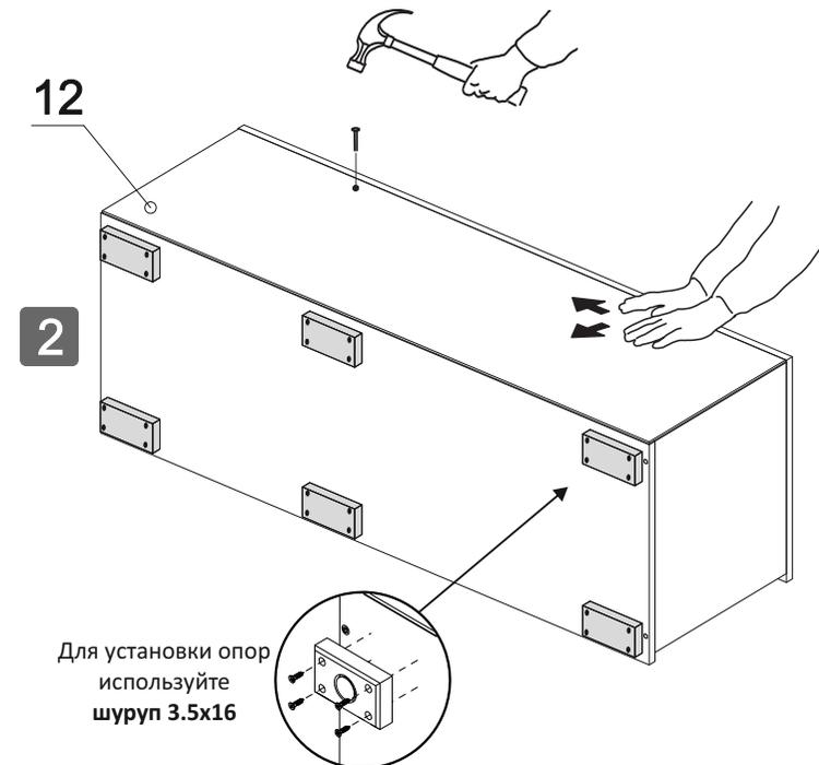
Для установки опор используйте шуруп 3.5x16
