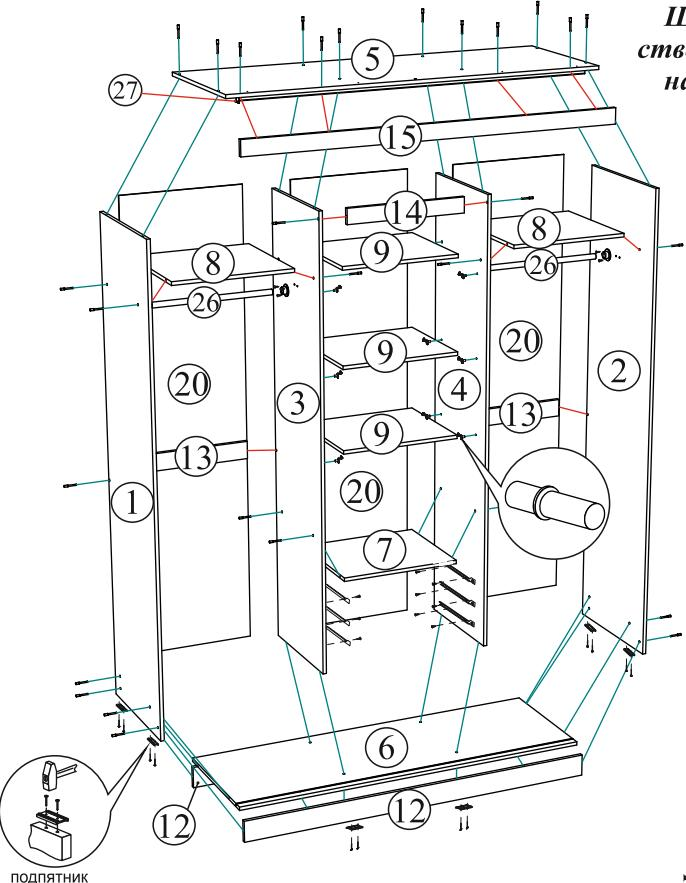
Направляющая СТ прикручивается на стяжки межсекционные 15 мм и дополнительно фиксируется шурупами 4x16
