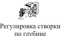
Регулировка створки по глубине
