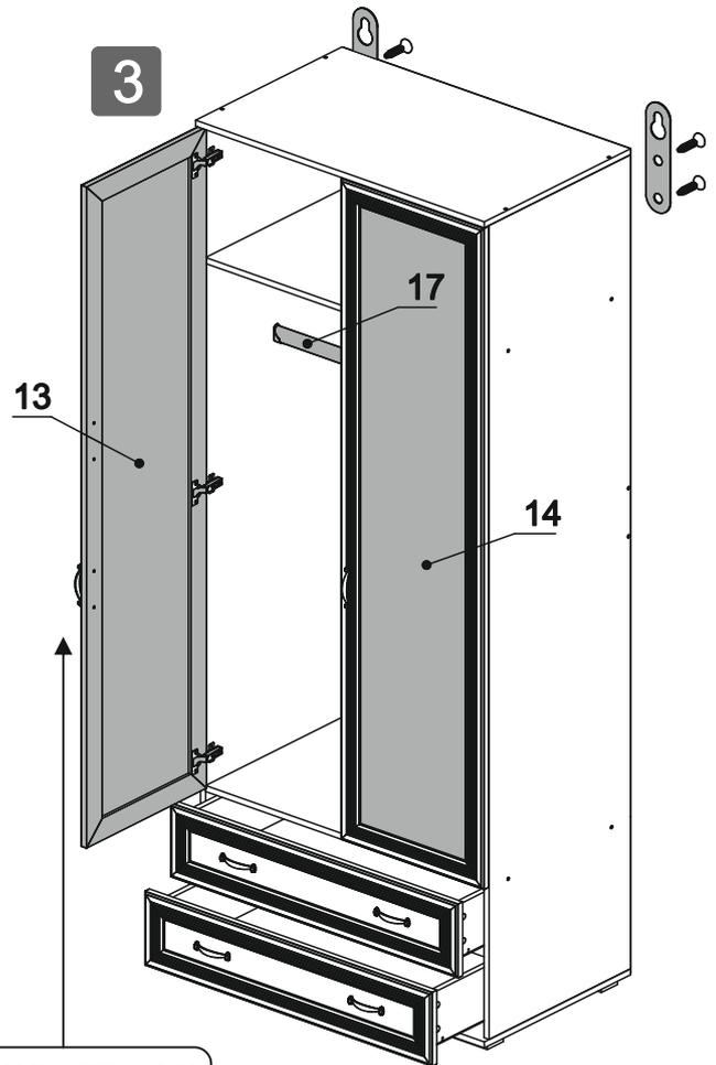
ДЛЯ УСТАНОВКИ РУЧЕК НА ФАСАДЫ (ДЕТ.№13,14) НЕОБХОДИМО ДОСВЕРЛИТЬ ГЛУХИЕ ОТВЕРСТИЯ СВЕРЛОМ Ø5MM
