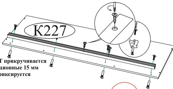
Направляющая СТ прикручивается на стяжки межсекционные 15 мм и дополнительно фиксируется шурупами 4x16
