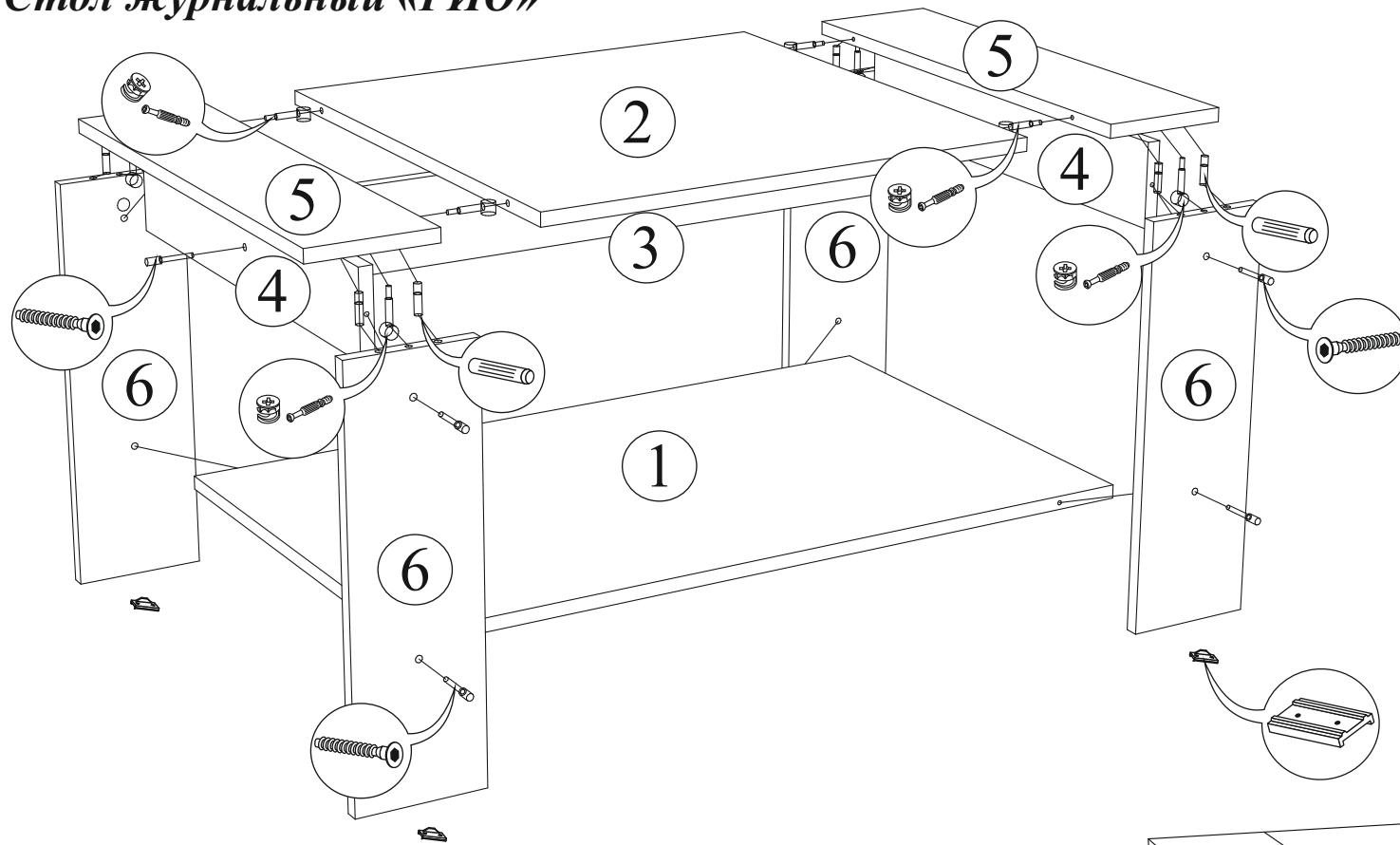
Монтаж эксцентриковой стяжки
