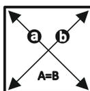
ЗАМЕРЬТЕ ДИАГОНАЛИ СОБРАННОГО КАРКАСА, ОНИ ДОЛЖНЫ БЫТЬ РАВНЫМИ (+/- 1,2ММ) (ТОЛЬКО ПОСЛЕ ЭТОГО МОЖЕТЕ ЗАКРЕПИТЬ ЗАДНЮЮ СТЕНКУ ИЗ ЛДВП ПРИ ПОМОЩИ ГВОЗДЕЙ)
